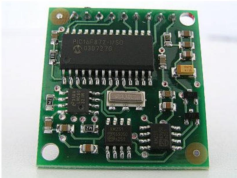
Das Kompassmodul CMPS03 ist der Nachfolger des inzwischen abgelösten CMPS01 und verwendet die Magnetfeldsensoren KMZ51 von Philips. Flexible Möglichkeiten und Bस्ताuglichkeit (wahlweise I2C oder PWM -Ausgabe) machen das Modul vor allem für den Profi interessant.
