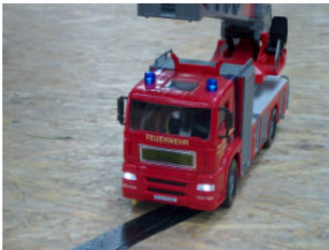
Die Robowehr ist mit einem **Handyboard** als Herzstück ausgerüstet. Dieses lässt sich über einen Computer programmieren. Die LCD-Anzeige des Controllerboardes ist das optische Ausgabeelement und von außen gut sichtbar als Kühlergrill angebracht.
