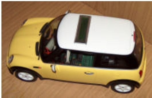
Das Handyboard ist gut für den Modellbau geeignet. Es ist leicht in Modellautos einzubauen. Dieses lässt sich dann über das Handyboard autonom steuern. Es lassen sich zum Beispiel Funktionen wie Licht, Blinker, Stopplicht oder Hupe naturgetreu ansteuern. Ebenso lassen sich die Lenkung und die Motoren einfach bedienen.
