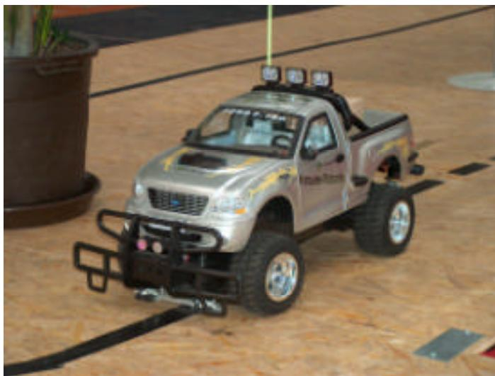
Der Handy-Ford F 150 ist ein voll funktionstüchtiges Modell im Maßstab 1:6 des bekannten Originals mit einem **Handyboard** als Steuercontroller ausgerüstet. Die Ankopplung von Sensoren und Aktoren an das Board ermöglichen eine naturgetreue und anschauliche Darstellung der Leistungsfähigkeit des Handyboardes.
