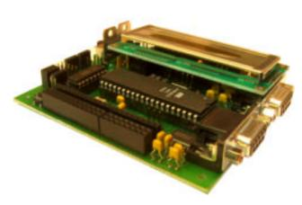
Das Atmelboard besteht aus nur einer Leiterplatte und einem Zweizeilen-Display. Als Herzstück arbeitet auf dem Board ein mit 16 MHz getakteter ATMEL ATmega 32. Dieser greift au f einen 32kByte großen nichtflüchtigen Speicher zurück. Da die Programmierschnittstelle direkt auf das Board montiert wurde erspart dies einen lästigen Programmieradapter. Zur Programmierung wird nur ein serielles Kabel benötigt.
